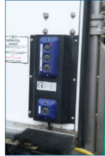
Platte wandbediening (ipv bedieningskast)
